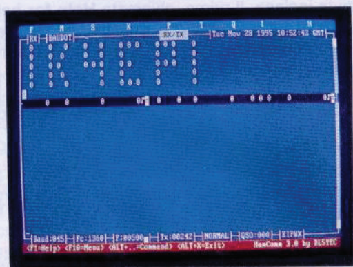
Fig.48 Pigiando i tasti ALT+T e selezionando le righe SEND TEXT e BANNER vedrete apparire la nostra sigla di fig.39.
