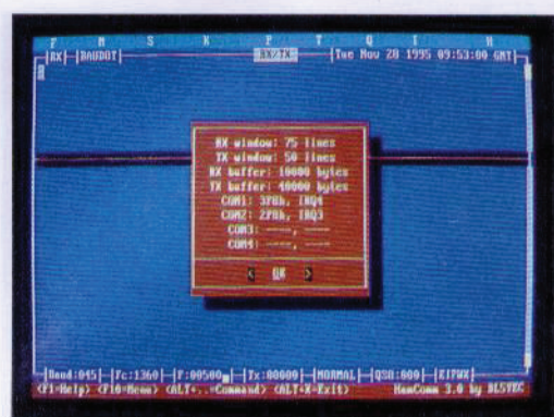
Fig.38 Selezionando la riga HAMCOMM apparirà questa finestra che riporta i parametri di settaggio.
