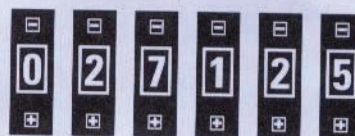
Fig.4 Se volessimo ottenere una frequenza di 27,125 MHz dovremmo inserire nel VFO il "modulo 1" ed impostare il numero 027.125 .
