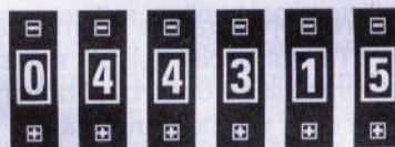
Fig.8 Se volessimo ottenere una frequenza di 443,150 MHz dovremmo inserire nel VFO il "modulo 6" ed impostare il numero 0.443.15 .
